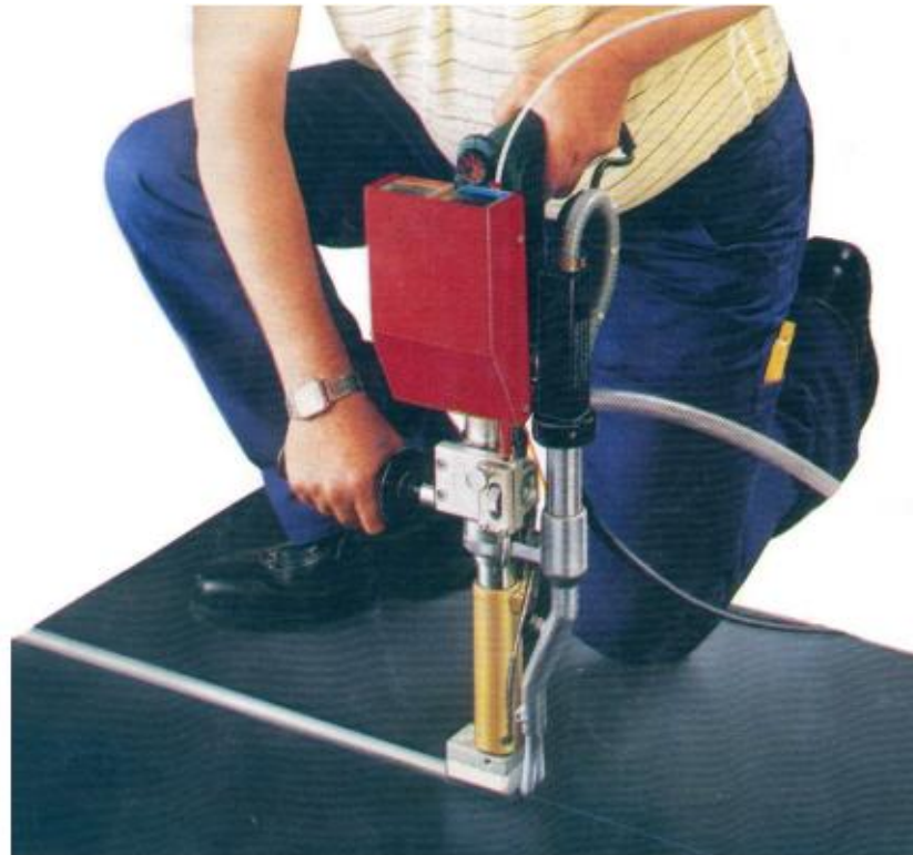
Rys. 9. Spawanie doczołowe płyt z PEHD spawarką ekstruzyjną
