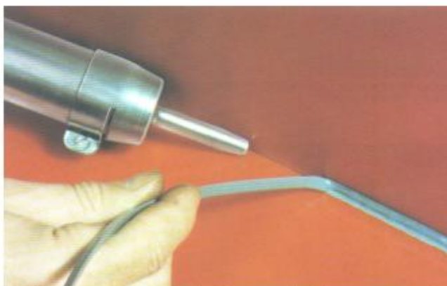
Rys. 6. Zobrazowanie prawidłowego nadlewu-wypływki przy wahadłowym spawaniu utwardzonego polichlorku winylu (PVC) i profilowanego pręta spawalniczego PVC.
