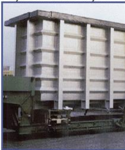
Rys. 1. Zbiornik do galwanizacji wykonany z polipropylenu (PP) technikami spawania. Szkielet jest stalowy pokryty przyspawanymi profilami z PP.
