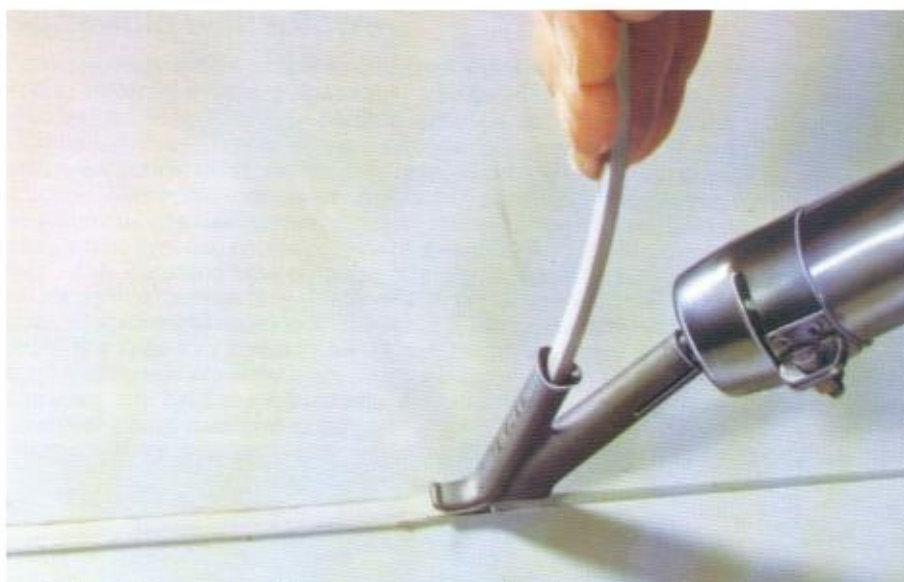
Rys. 4. Spawanie płyt z PP drutem profilowym z zastosowaniem dyszy spawalniczej.
